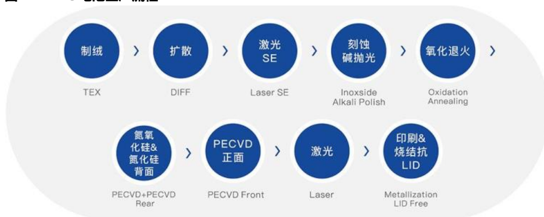
图 11 PERC 电池生产流程
