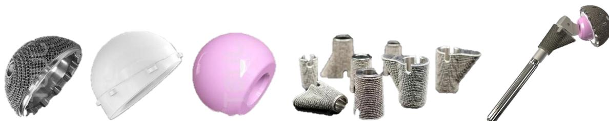
其产品技术均为国际领先，3D 打印材料为进口钛合金粉末，临床证明 3D 打印钛合金与传统植入物有等效生物相容性；其骨小梁白杯高度多孔表面的摩擦系数比普通涂层白杯提高了 40%-75%；打印所使用的电子束熔融（EMB）工艺，能够使骨小梁结构一体成型，多孔层与实体的无界面，避免表层脱落风险，利于远期骨整合。
